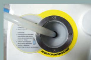
Ouvrez la vanne de vidange du bac des eaux usées. Remplissez le réservoir désinfectant avec de l'eau et du désinfectant REVAL PROTECT. Démarrer la désinfection automatique du circuit d'aspiration des eaux sales jusqu'à ce que le réservoir de désinfectant soit vide.
