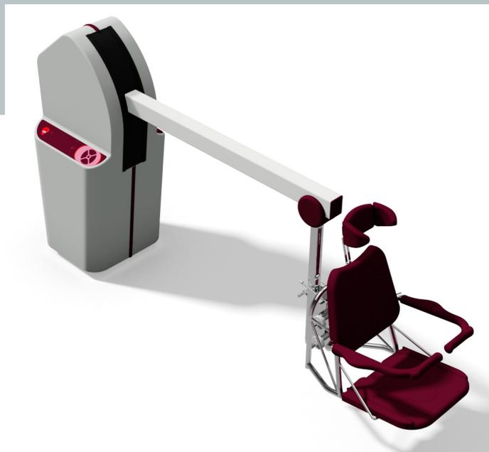
POSEIDO XL assure le transfert des personnes à mobilité réduite pesant jusqu'à 220kg, du bord vers l'intérieur du bassin, en toute sécurité. Il est fixé au sol et dispose d'une amplitude qui lui permet de s'adapter aux bassins encastrés comme aux bassins surélevés. Ses systèmes de rotation et de montée-descente électrique sont commandés à distance et permettent d'accéder à la piscine sûrement et sereinement, pour le patient assis. Il est adapté à toutes les pathologies.
